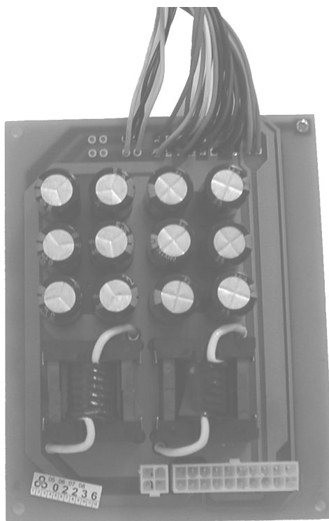
Рисунок 1. Общий вид платы фильтра в составе компьютерного блока.
